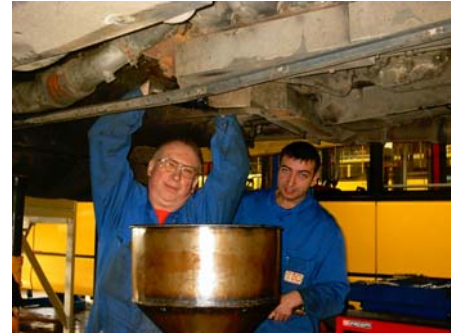
Photo 4 : Vidange d'un bus du TEC : un essai avec une huile moteur additivée d'esters végétaux ne tient pas ses promesses.
