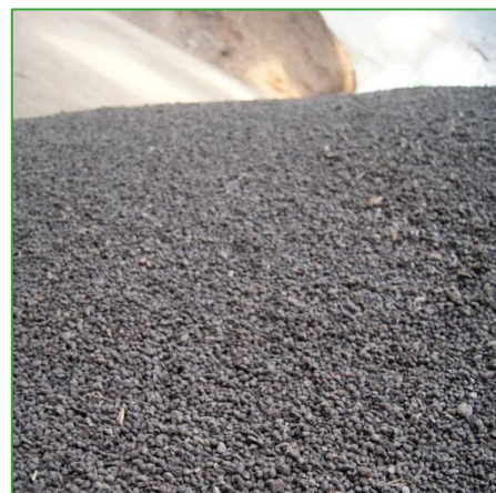
Digestat séché sous forme de granulés (© ValBiom)
