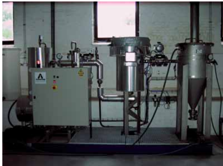
Figure 5. L'explosion à la vapeur comme exemple de prétraitement (Courtoisie : N. JACQUET et al., GxABT)
