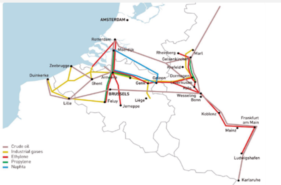
Figure 10 Réseau de pipelines entre les usines pétrochimiques de Belgique, des Pays-Bas et d'Allemagne. (essencia, 2013). bib.53
