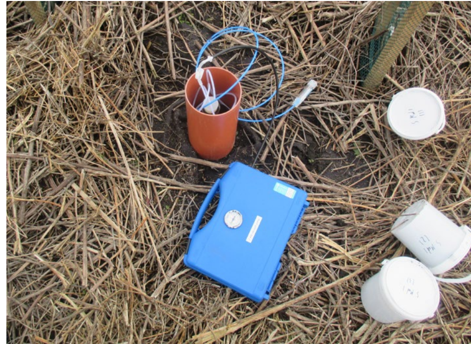
Bougie poreuse installée dans une cellule pour récupérer l'eau interstitielle.
